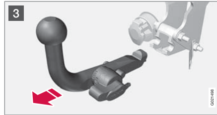
3 Otočte zajišťovací kolečko zcela dolů až na doraz. Držte je v této poloze a přitom vytáhněte kouli tažného zařízení dozadu a nahoru.
