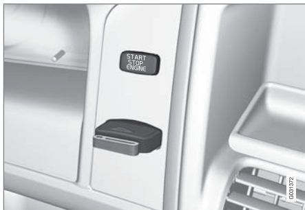
Spínač zapalování s vloženým dálkovým ovladačem s klíčem a tlačítko START/STOP ENGINE .
